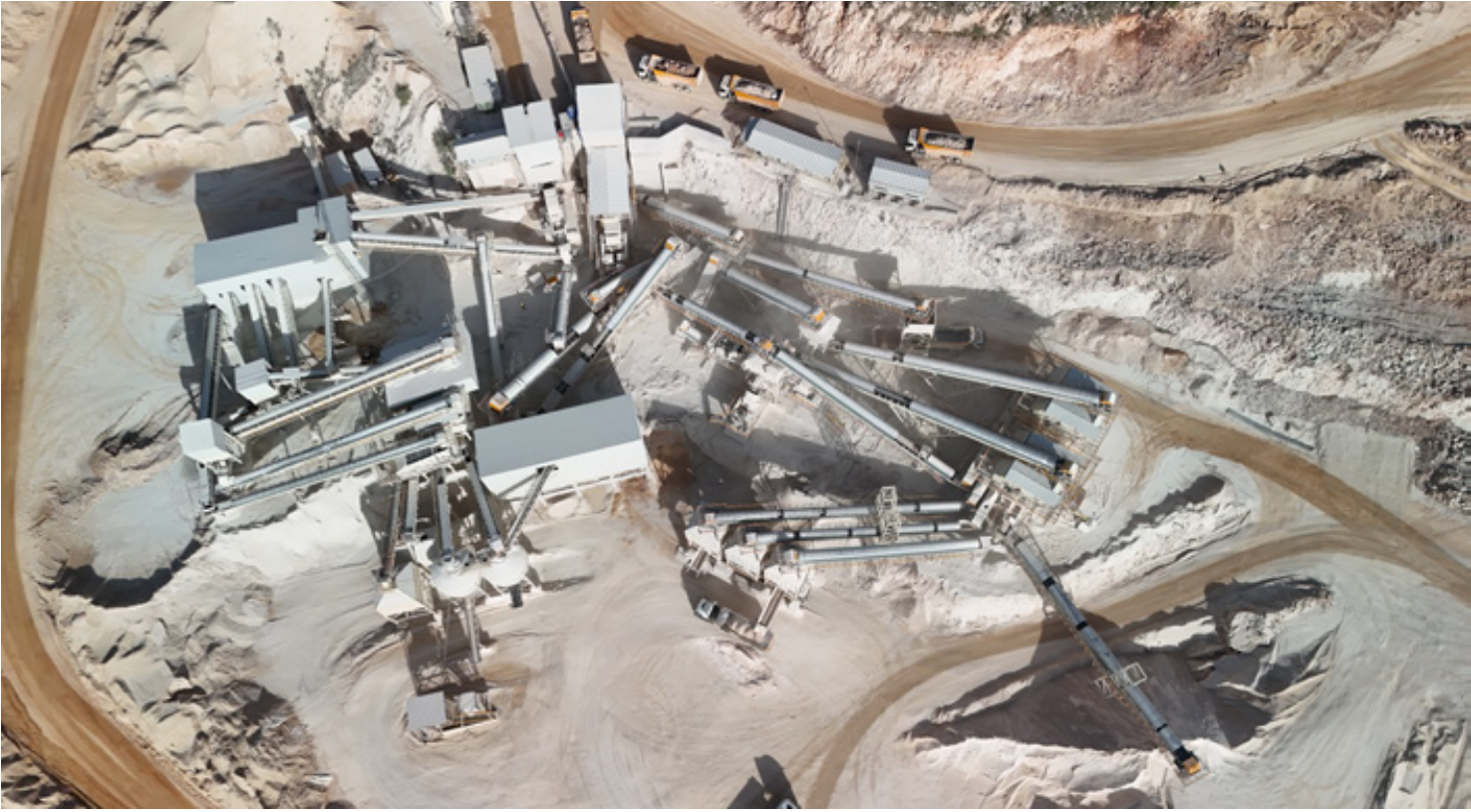
▲ Tesis otomasyon yazılımından tesis tasarımı ve tüm mühendislik ve üretim süreçleri MEKA tarafından gerçekleştirilen Gaziantep'te kurulan önemli Türkiye Agregat üretimi referanslarında 1000 ton/saat kapasiteli Cantoma Tesisinden görüntüler
